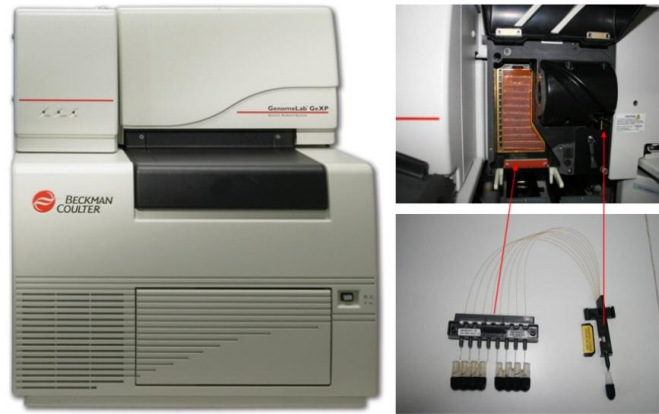
Figura 5. Fotografía de un secuenciador automático GeXP. Imagen de la izquierda: vista frontal externa del equipo. Imagen superior derecha: estructura protectora de los capilares encargada del control de la temperatura, las flechas indican donde se sitúan las zonas de inyección y detección del sistema de capilares. Imagen inferior derecha: array de 8 capilares, compuesto por tres zonas – inyección/migración/detección.
