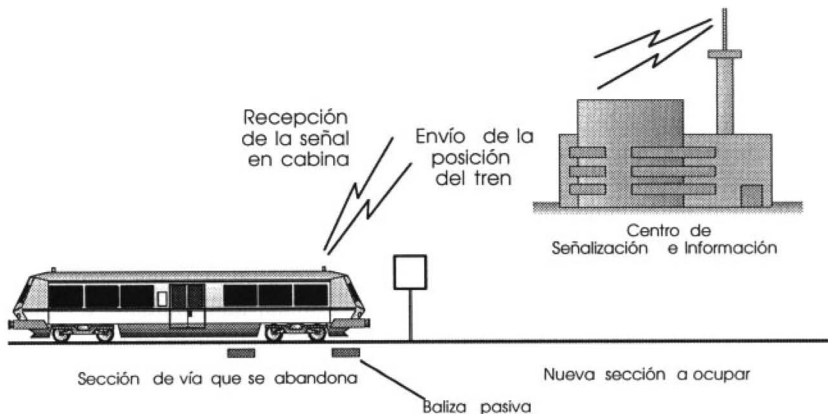
Figura 7.- Señalización por radio.
