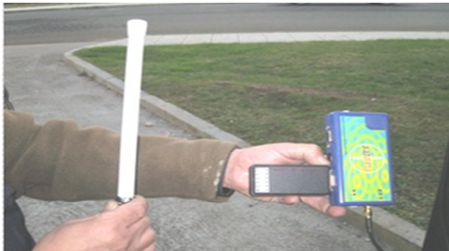
Modulo de comunicaciones GPRS con su antena emisora.
