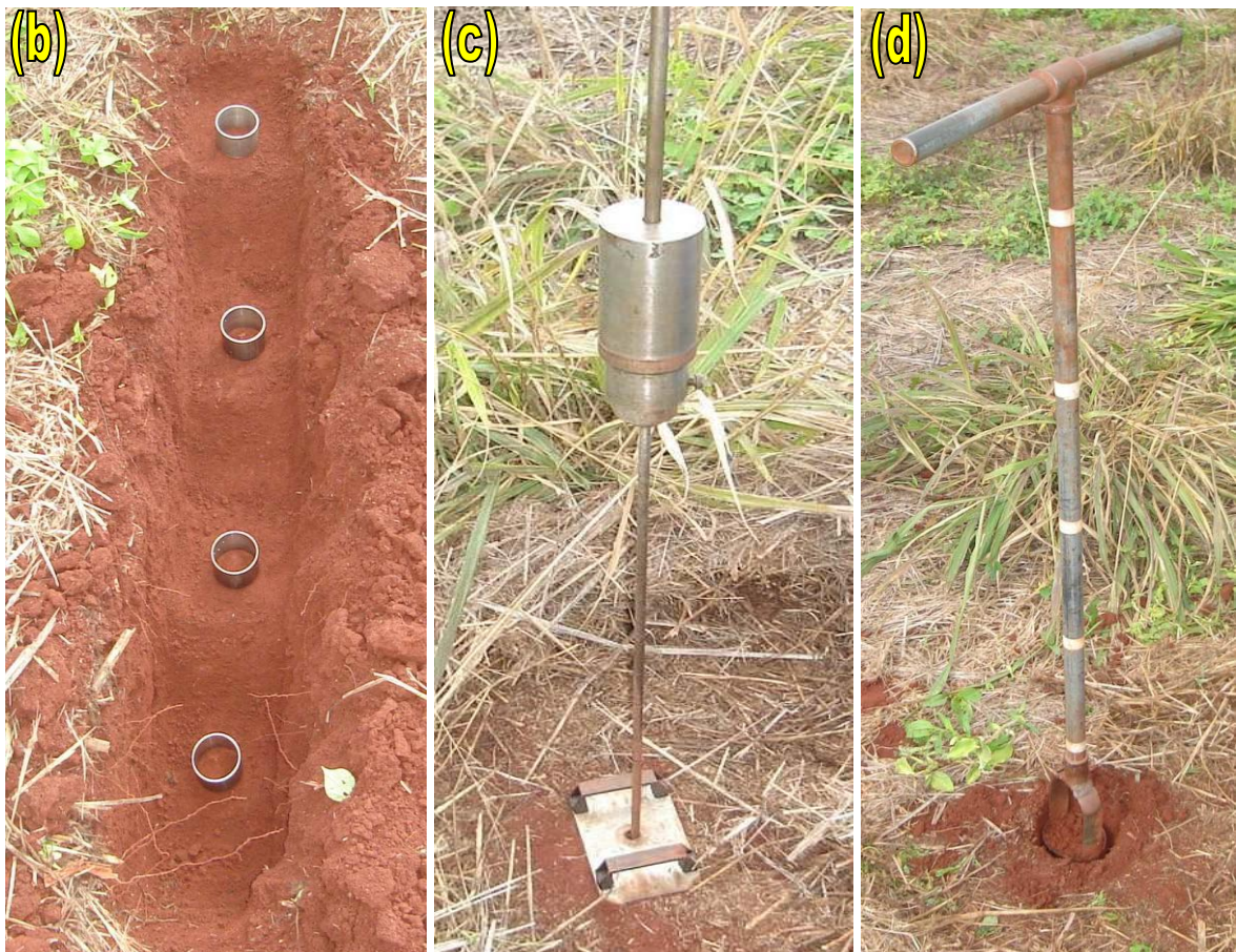
APÊNDICE A. (a) Área experimental antes da dessecação/semearia da soja; (b) Vista da coleta das amostras indeformadas do solo; (c) Detalhe da coleta da resistência à penetração, e (d) Coleta de amostras deformadas do solo.
