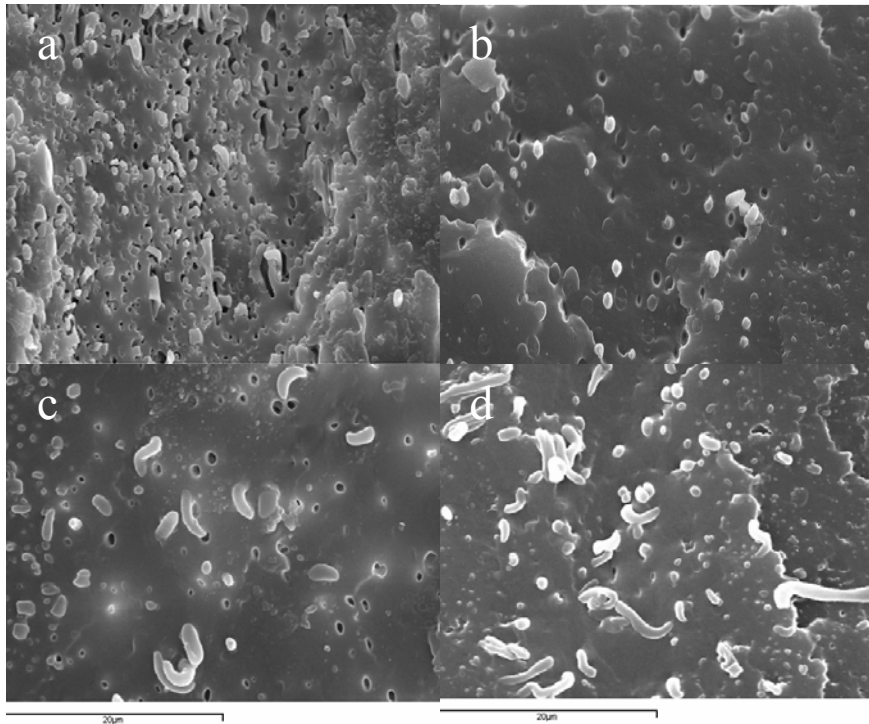
Figura 7.17. Micrografías SEM (x3000) del film 80/20/10 PP/EVOH/ionómero Na + con distintas velocidades de estiramiento: (a) 3,5 rpm, (b) 4,5 rpm, (c) 5,5 rpm, (d) 6,5 rpm
