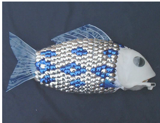
Fig. 9 Prototipo de pez robot, denominado G-9, desarrollado en la Universidad de Essex
