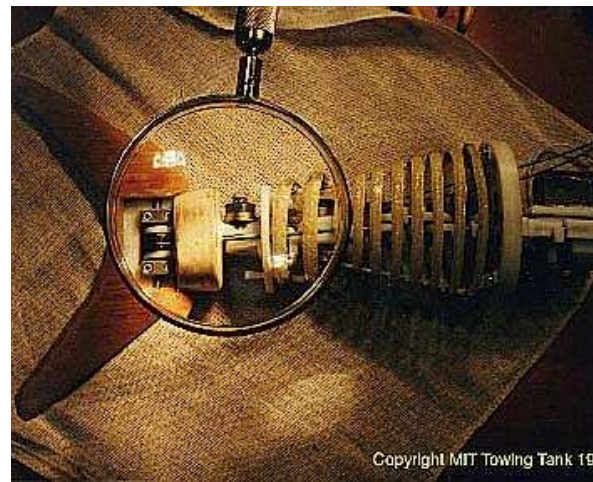
(b) Detalle de la articulación de la aleta caudal
