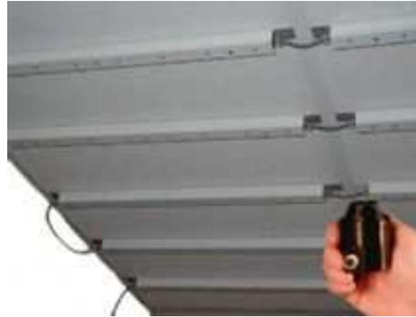
(b) Colocación de los emisores del HiBall en el techo.
