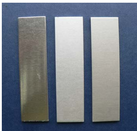
Figura 3. Comparación del aspecto superficial de la aleación de referencia (izq), decapada (centro), y anodizada (derecha).
