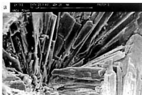
Fig. 7. Agregados e hábitos cristalinos próprios de diferentes condições de deposição. Imagens de MEV (ES). a) Gesso; b) Enxofre nativo sobre gesso+rozenite.
