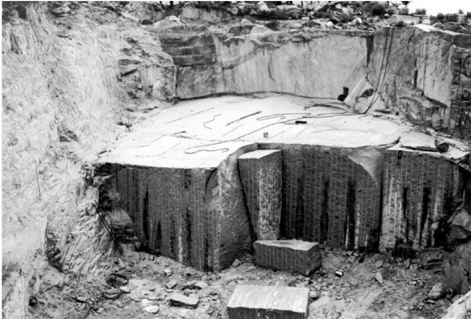
Fig. 14. Pedreira no bordo SW do maciço de Esmolfe. Notar a zona de alteração côncava ao fundo, que constitui o limite da pedreira.
