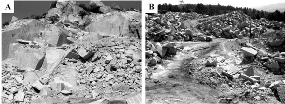
Fig. 15. A) Pedreira próximo de Pedras Altas onde é evidente a inadequada orientação técnica da exploração e com deficientes condições de segurança no trabalho; B) deposição de escombros em zonas promissoras.
