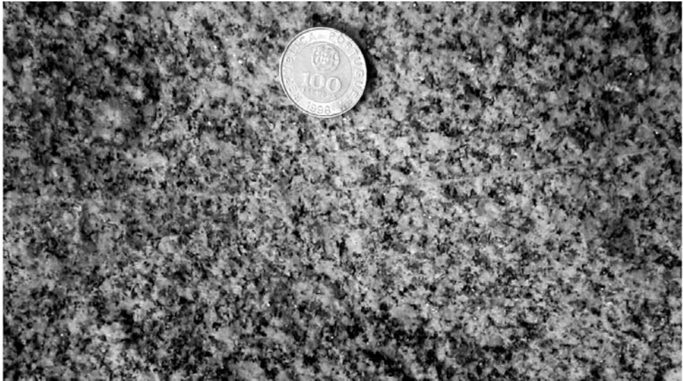
Fig. 17. Descontinuidade no granito provocada por pequeno filonete de quartzo. As fracturas são frequentemente causadas pelo alinhamento de minerais, em geral micas. Defeito comum no granito da zona de Antas, muitas vezes dificilmente perceptível antes do desmonte.
