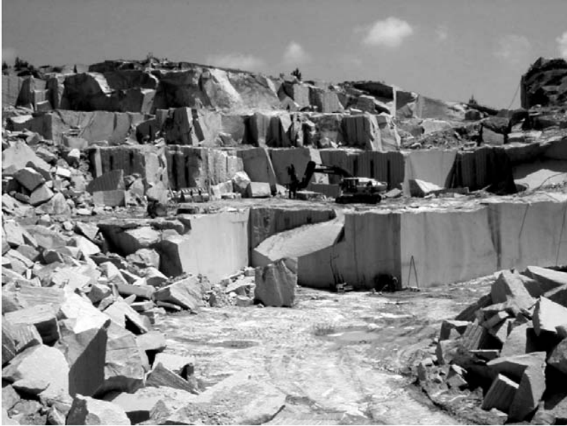
Fig. 12. Aspecto geral da pedra da Incoveca, em Antas. Notar a diminuição da densidade de fracturação do topo para a base da pedra, onde há quase ausência de fracturas.
