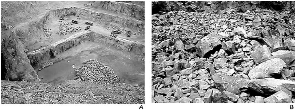
Fig. 4. Panorâmica do maciço rochoso da pedreira da Malaposta (A) e um exemplo de amostragem dos fragmentos do material-rocha gnáissico (B).
