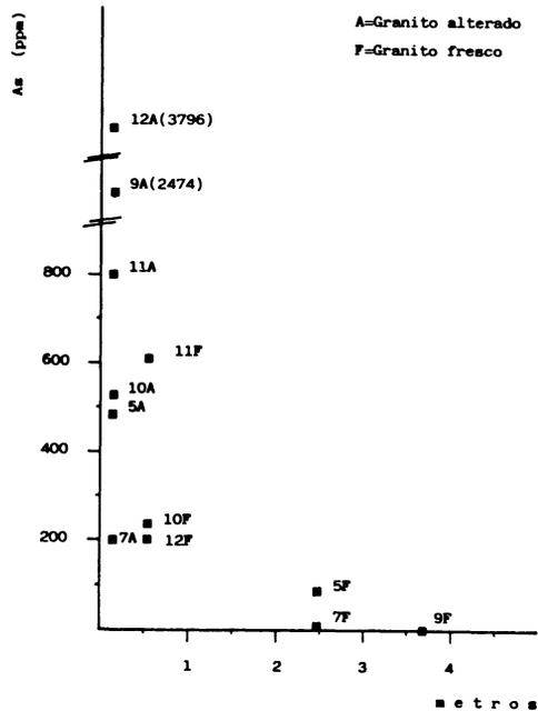
Fig. 6. Contenido de As en el granito en función de la distancia al filón.
