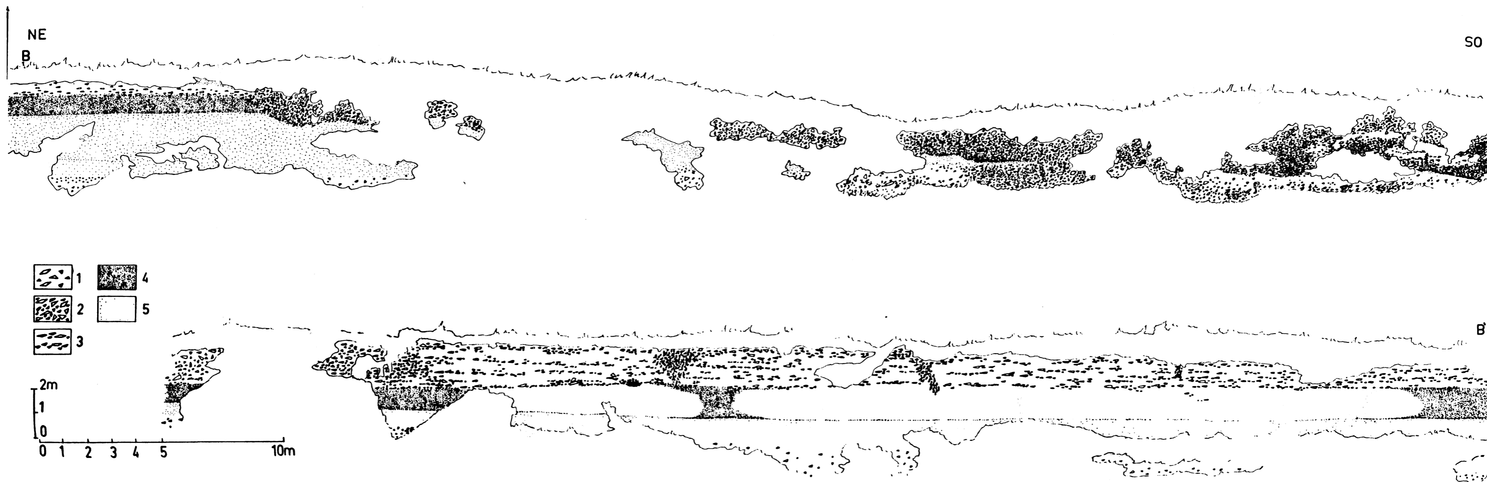
Fig. 10. Reconstrucción parcial a partir de diapositivas del afloramiento de Ponzos. 1: cantos angulosos dispersos en una matriz fango-arenosa; 2: cantos angulosos con matriz microconglomerática y fango-arenosa; 3: lechos de cantos angulosos interestratificados con material fino (fango-arenoso); 4: material fango-arenoso con cantos angulosos dispersos y partículas carbonosas igualmente dispersas; 5: arenas.
