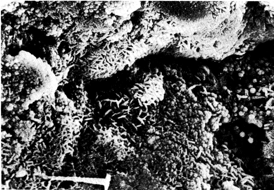
Fotg. 4. Muestra MdC-3. Formas aciculares y globosas de los óxidos de hierro (2.500 x).
