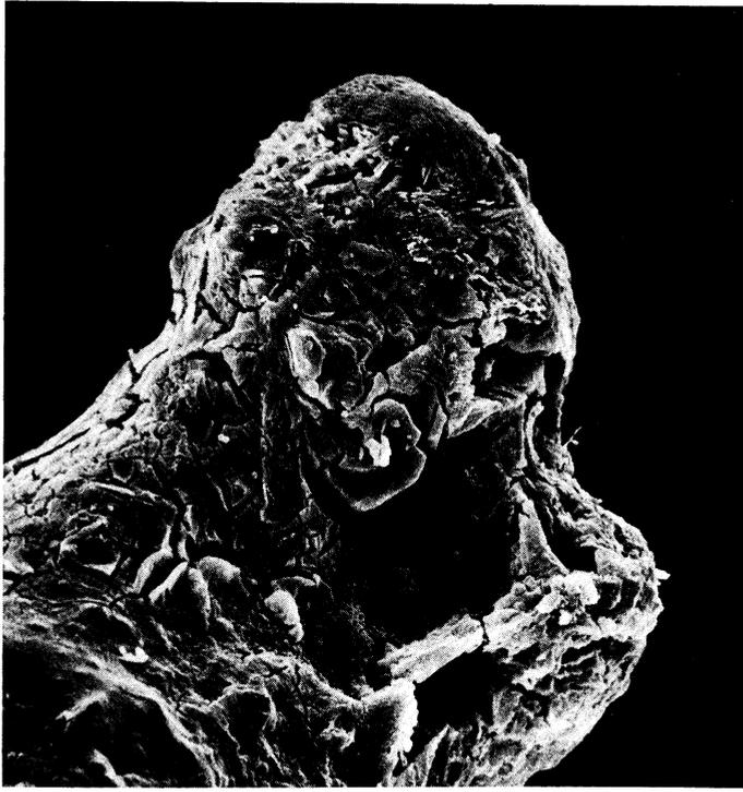
Fotografía n.º 3.—Detalle del extremo libre del espeleotema. Obsérvese el aspecto profundamente cuarteado típico de la sílice desecada. Aumento total 504.
