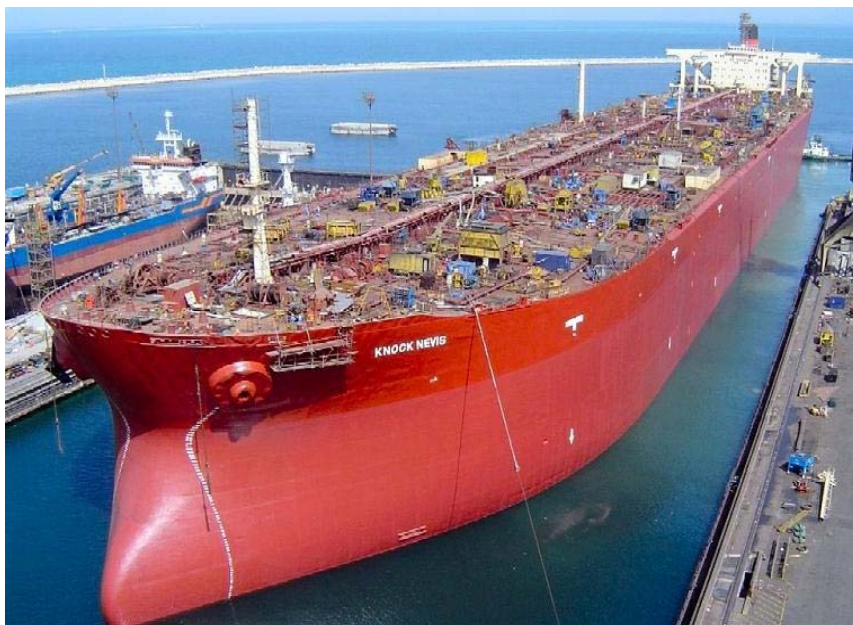
Figura 2.26. Knock Nevis, mayor superpetrolero del mundo. Capacidad 560.000 t de petróleo, eslora: 458 m.
