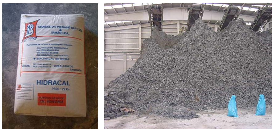
Figura A.3. Materiales empleados en el proceso de pre-estabilización y también en el de estabilización. Izq: Cal comercial. Der: Serrines de granito a la salida de los filtros prensa.
