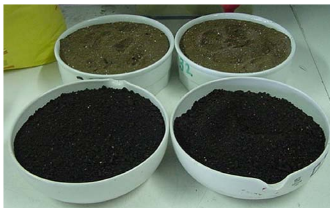
Figura 6.4. Aspecto de algunas de las mezclas estabilizadas. La inferior contiene mayor porcentaje de fuel.
