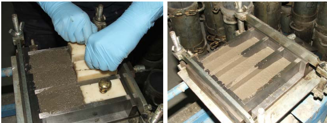
Figura 8.10. Ensayo de energía de compactación empleado. Izquierda, retirada de obstáculos. Derecha, estado final tras aplicar los golpes necesarios para que el mortero alcance el extremo opuesto del molde.
