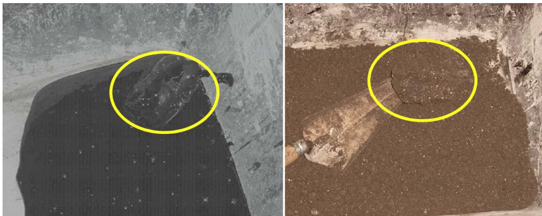
Figura 6.6. Inicio y fin del proceso de estabilización. Se destaca un trozo de poliestireno expandido que estaba mezclado con el fuel del Prestige. Tras 2 horas de reposo, puede ser separado sin dificultad.
