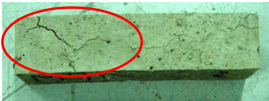
Figura 8.1. Probeta afectada por expansiones causadas por reacciones diferidas de la cal viva. Este problema se solucionó al eliminar la fracción de la cal superior a 0,4 mm.
