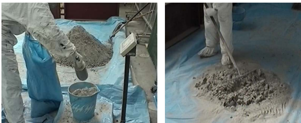
Figura 6.8. Dosificación y amasado en la experiencia de estabilización con residuo impuro
