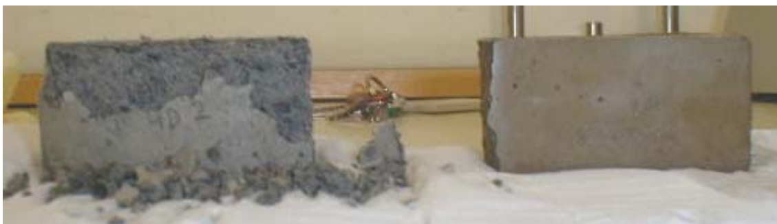
Figura 8.12. Estado de probetas tras 20 ciclos hielo-deshielo. Izquierda, mortero de referencia sin fuel. Derecha, probeta con un 9 % de fuel
