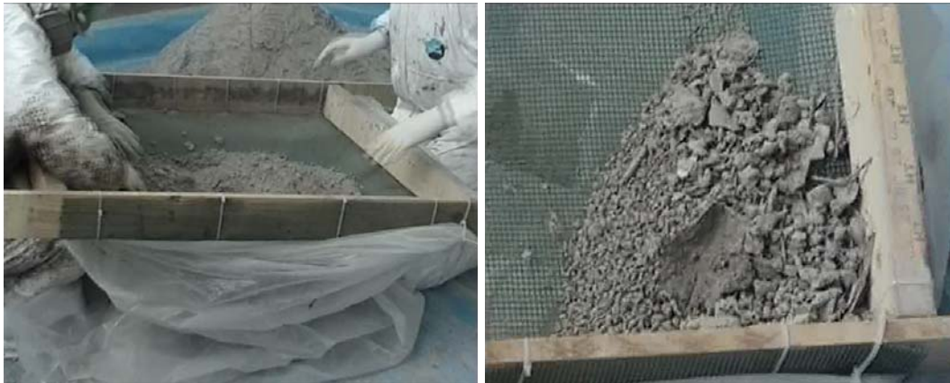
Figura 6.9. Tamizado del residuo estabilizado y detalle del retenido tras el cribado en la experiencia de estabilización con residuo impuro
