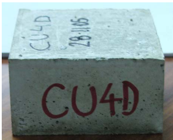
Figura 8.14. Probeta empleada en el ensayo de desgaste
