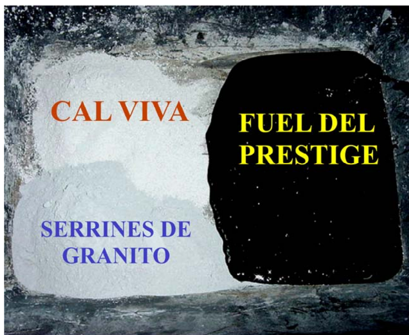
Figura 6.1. Materiales empleados para la estabilización.
