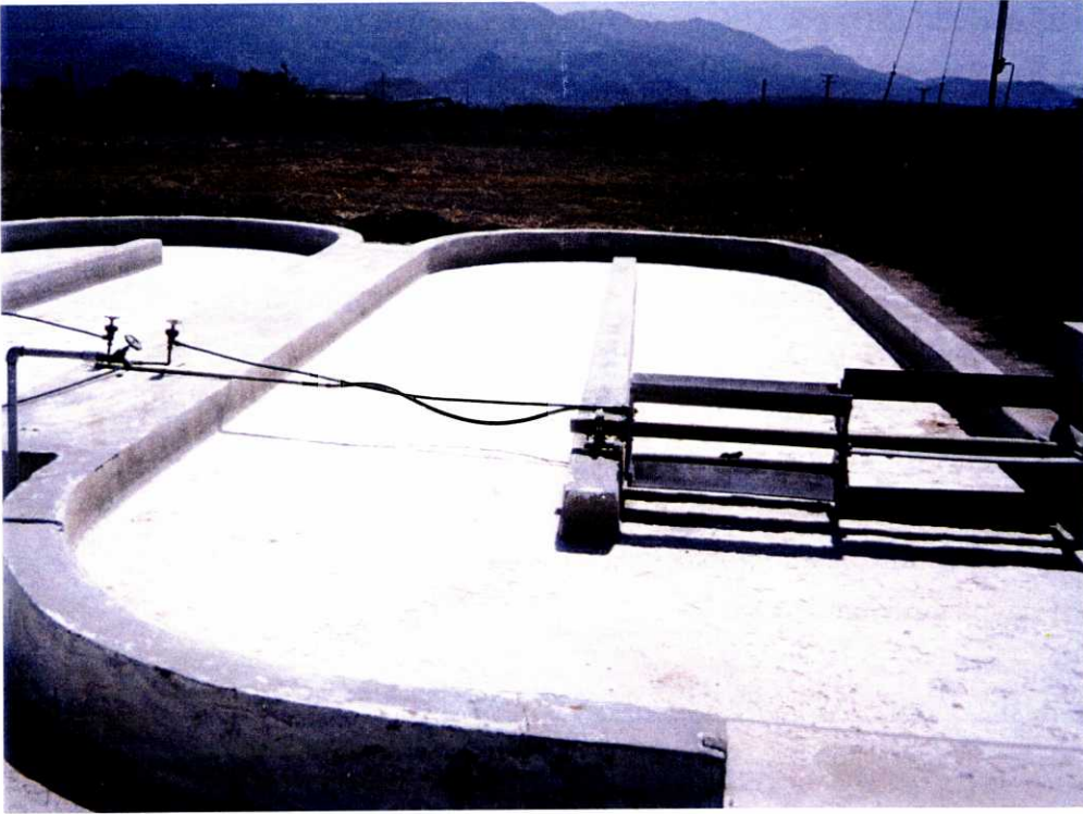
Figura 4. Sistema de cultivo en canales de Dunaliella salina a gran escala (50 m 2 ). Centro de Investigaciones de Energía Solar, Santiago de Cuba, Cuba.
