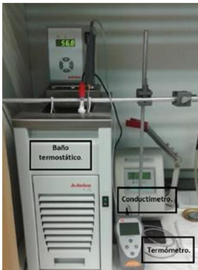
**Figura 9.** Conductivímetro Crison GLP 31.
