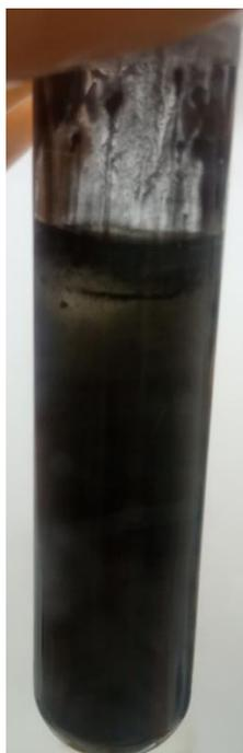
**Figura 5.** Aspecto de la muestra del ionanfluido a concentración de 2,484% m/m de grafeno en el líquido iónico DMIM-BF<sub>4</sub>.
