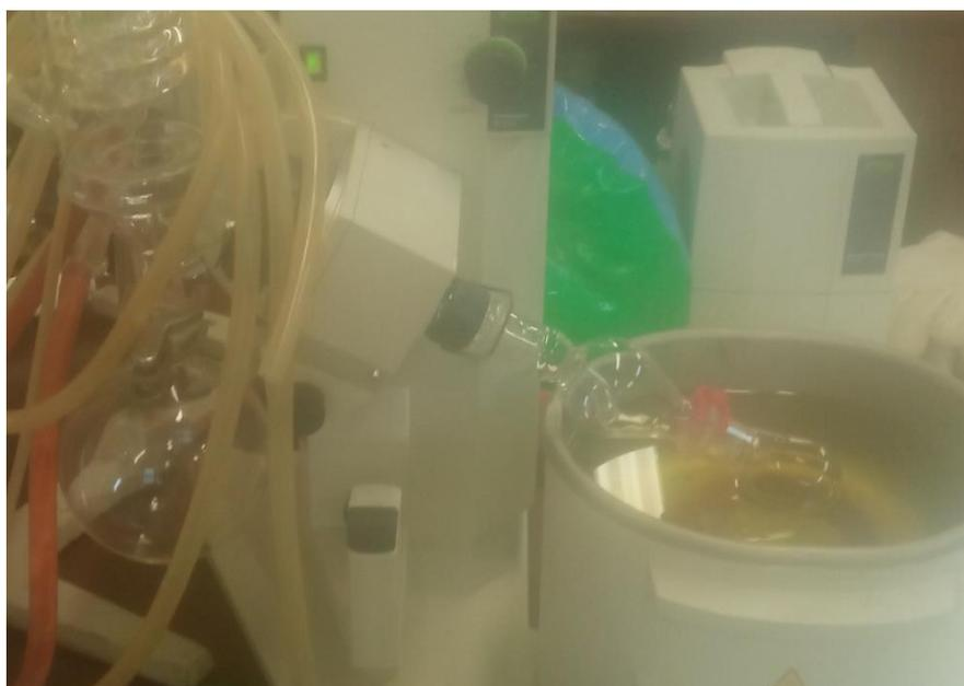
**Figura 8.** Imagen tomada del líquido iónico DMIM-BF<sub>4</sub> mientras se encuentra a 50°C en el rotavapor BUCHI R-210 acoplado a una bomba de vacío BUCHI V-700 y a un baño térmico BUCHI B-491.
