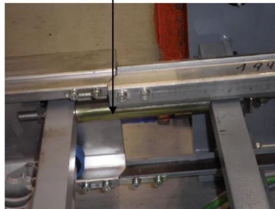
EN LAS UNIONES ENTRE CABEZA Y TRAMO RECTO LAS PLETINAS UNIÓN SON DIFERENTES Y ADEMÁS SE INSTALA UN SEPARADOR EN LA VARILLA
