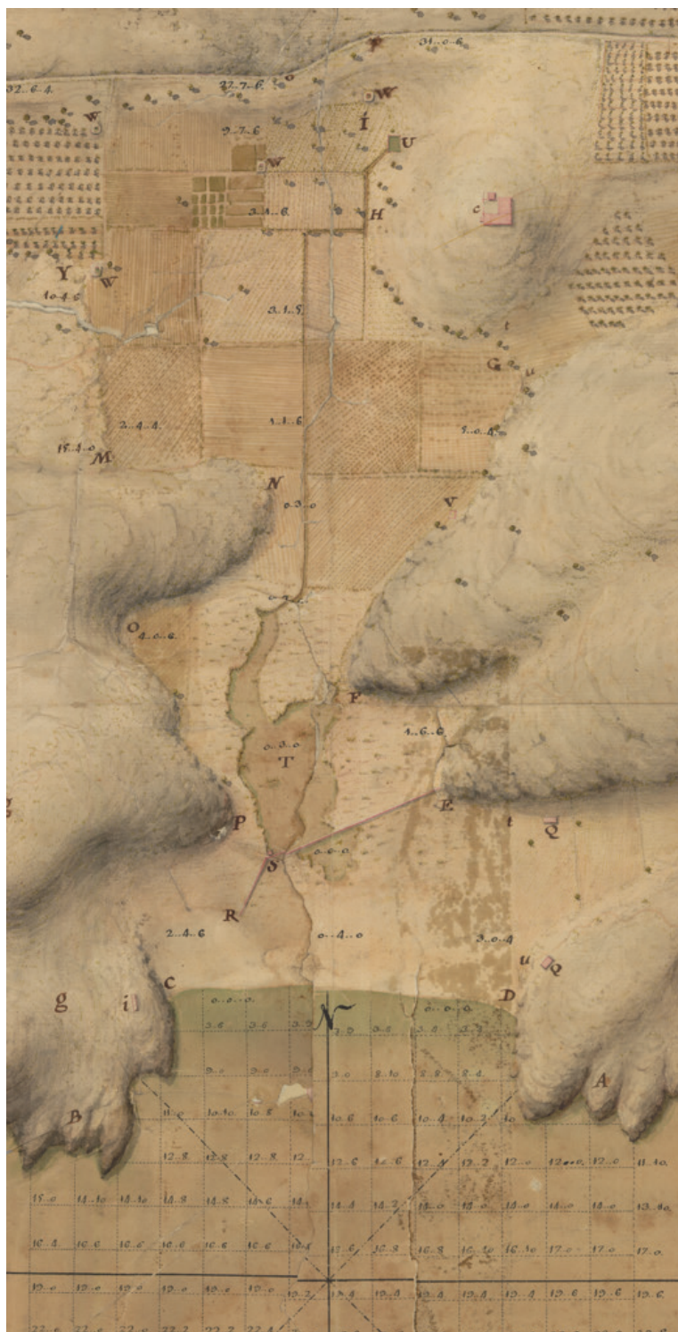
FIG. 9. DETALLE PLANO TOPOGRÁFICO DE LA PLAYA DE LA MORA Y VALLE DEL MEDO... TARAMAS SEÑALA EN PIES Y PULGADAS DE BURGOS LA PROFUNDIDAD DE LA CALA Y LA ALtura SOBRE EL NIVEL DEL MAR EN CADA ZONA DEL VALLE. C-D. PLAYA DE LA MORA. E-S-R. DIQUE CON ESCLUSA PARA EVITAR QUE LAS AGUAS DEL MAR INUNDEN EL VALLE. T. PANTANO O LAGUNA. U. ALBERCA QUE RECIBE EL AGUA DEL RÍO GAYÁ POR UN CONDUCTO SUBTERRÁNEO PARA REGAR LAS TIERRAS DEL VALLE. W. NORIAS QUE SUPLEN EN VERANO EL DÉFICIT DE LA ALBERCA. C. MASÍA DE FRANCISCO MARQUÉS
