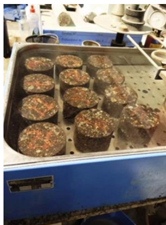
Figura 14. Probetas experimentales sometidas a inmersión.
