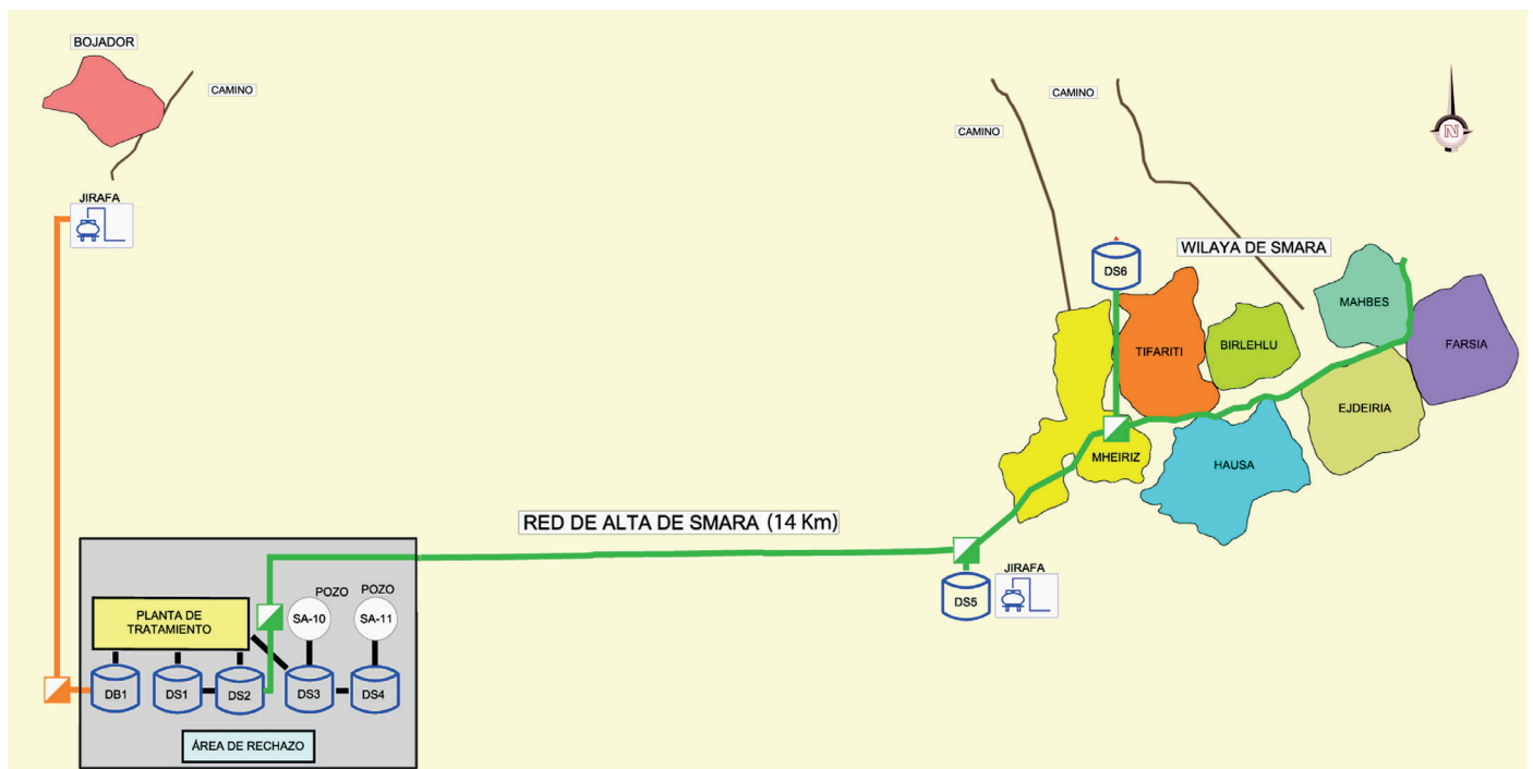
Figura 2 | Esquema del sistema de abastecimiento de la Zona II que abastece las wilayas de Smara, Bojador y el centro institucional de Rabuni (fuente: SIA).
