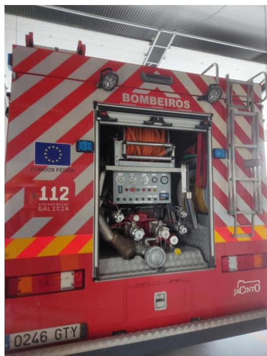
Imagen 30: Conexiones para distintas mangueras. Fuente: Propia
