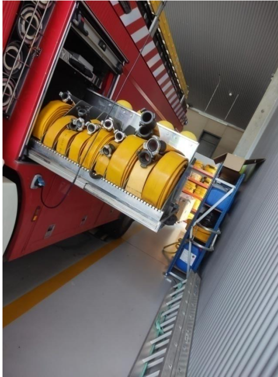
Imagen 28: Mangueras para la lucha contra incendios. Fuente: Propia
