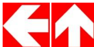
Indicación para localización de algún medio de lucha contra incendio
