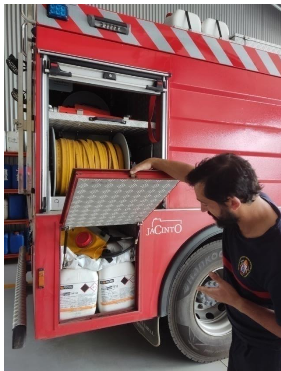
Imagen 29: Material (espumas) para la lucha contra incendios. Fuente: Propia
