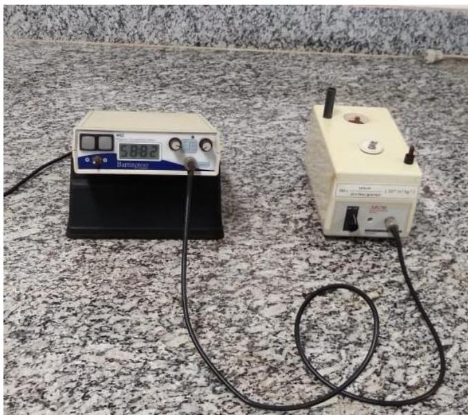
**Figura 4.** Aparelho de Bartington MS2 para a leitura da susceptibilidade magnética.
