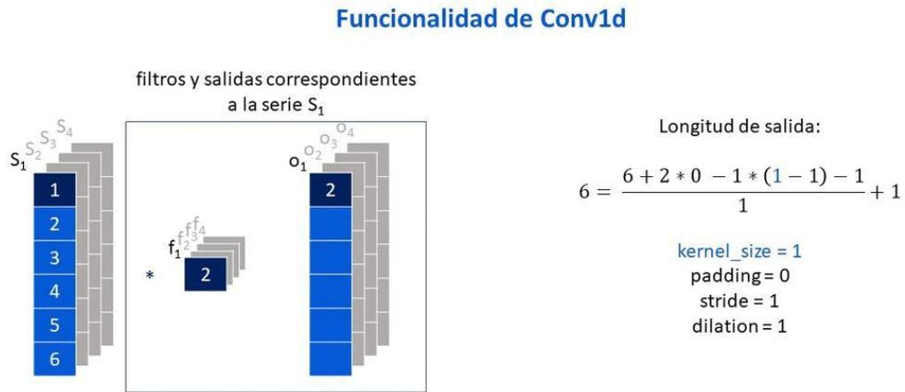
Elaboración propia: Elaborada a partir de Jing (2020). Muestra como el tamaño del vector de salida cambia según el tamaño de filtro que se usa.
