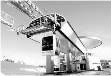
Estación de telecabina desembragable. Se aprecia el sistema de llegada y salida. Fabricante: Poma
