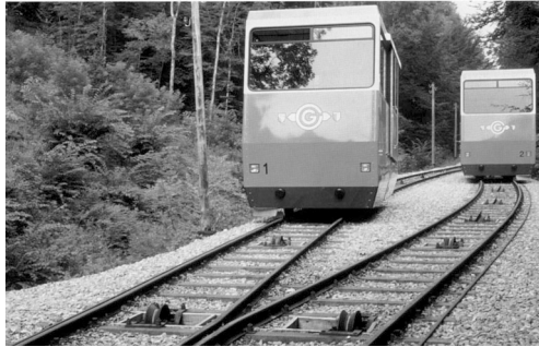
Funicular Cossonay Gare-Ville. Obsérvese la inclinación de las poleas en la zona curva.
