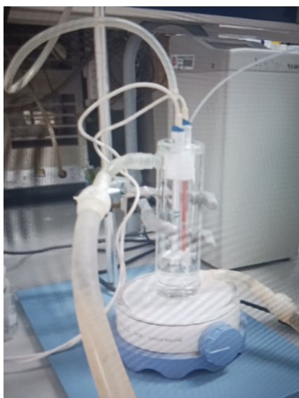
Figura 17. Montaje de la valoración potenciométrica.
