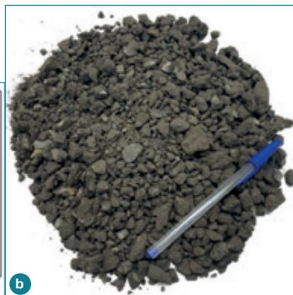
Figura 1. (a) Distribución granulométrica del RAP y husos del PG-4, (b) Detalle del RAP 1.
