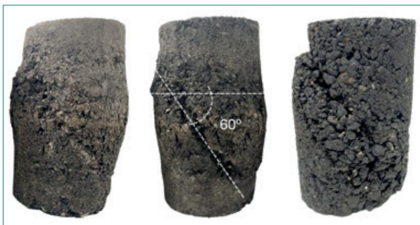
Figura 12. Probetas tras ser sometidas a ensayos MTX. Inclínación del ángulo de rotura aproximadamente 60°.
