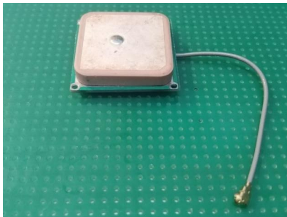
Figura 4.2.1.3. Antena activa cerámica. (Fuente: original del autor)
