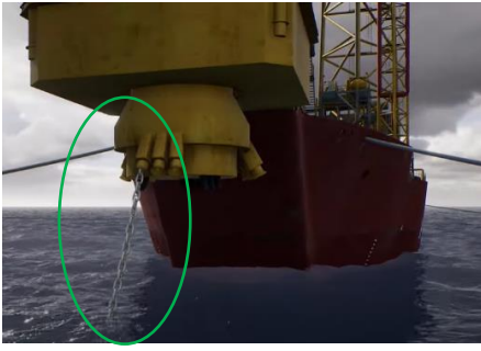
Figura 3.3.7.9: Catenaria largada pola FPSO 42 Figura 3.3.7.10: Conexión cable de traballo e catenaria da FPSO (MAERSK SUPPLY SERVICE, 2021)
