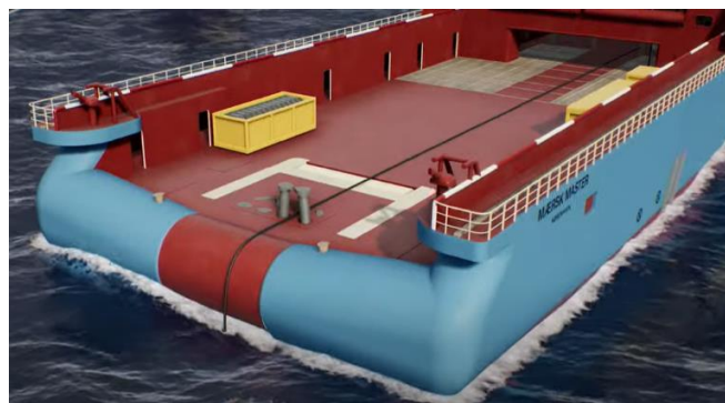
Figura 3.3.7.5 : Cable de traballo de estribor largado, coa lonxitude de cadea final conectada ao gancho para posterior virado da cadea Pre – Lay (MAERSK SUPPLY SERVICE, 2021).
