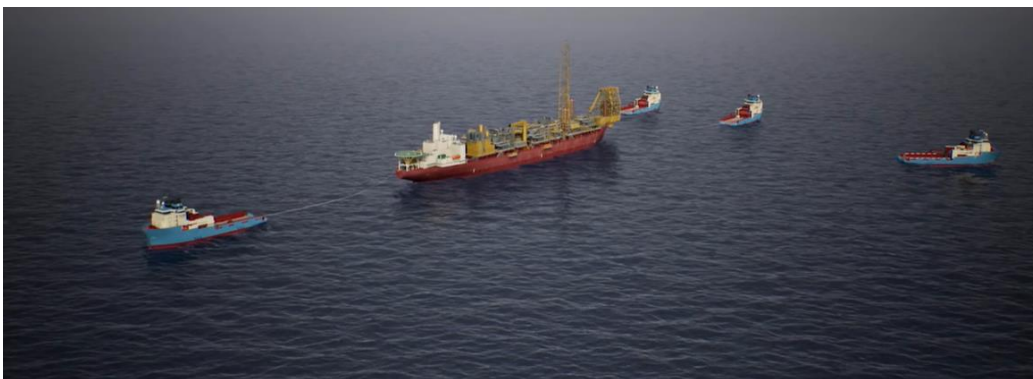
Figura 3.3.7.1: Remolque dunha FPSO por varios AHTS (MAERSK SUPPLY SERVICE, 2021)
