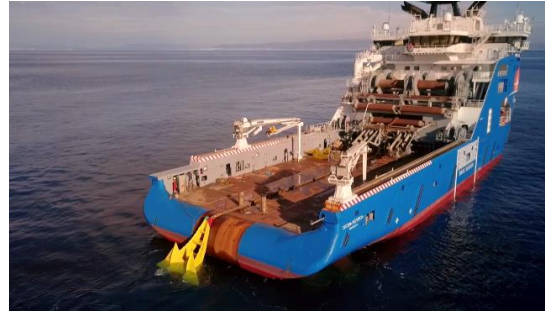
Figura 3.3.5.2: Áncora posicionada no rodillo de popa.
