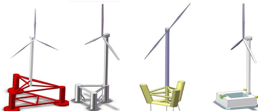
Figura 4.3.1: Diferentes configuracións para estruturas semi-somerxibles (Liu et al., 2016)
