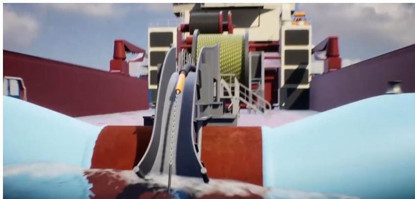
Figura 4.4.2. : Conexión do mensaxeiro co cable eléctrico a bordo do AHTS adaptado para o largado do cable (MAERSK, 2020).
