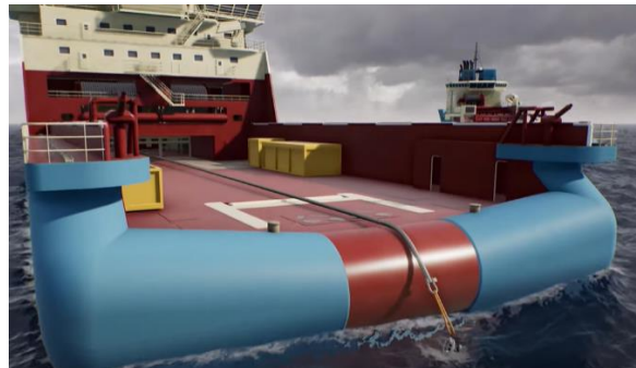
Figura 3.3.7.13 Liberación de Sharkyaws e Guide Pins , Figura 3.3.7.14: Largado de cable de traballo central (MAERSK SUPPLY SERVICE, 2021)
