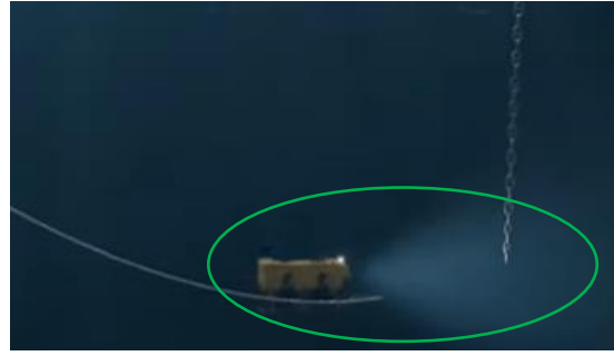
Figura 3.3.7.9: Catenaria largada pola FPSO 42 Figura 3.3.7.10: Conexión cable de traballo e catenaria da FPSO (MAERSK SUPPLY SERVICE, 2021)
