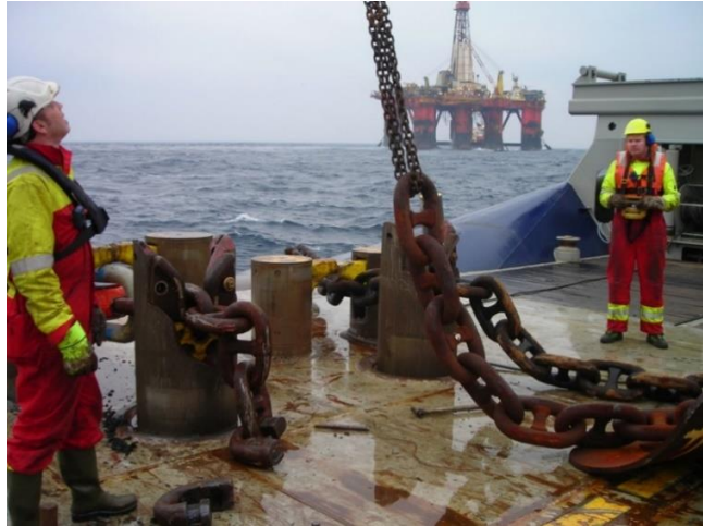
Figura 1.4.1: Operativa de Shark Jaws retráctiles a bordo dun AHTS (Kongsberg, 2023)
