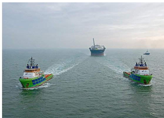
Figura 3.3.6.1 : Remolque dunha MOU por parte de varios AHTS. (Fairmount Marine, no date)
