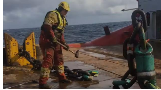
Figura 3.3.5.6 e Figura 3.3.5.7: Cadea fixada en cuberta nun Sharkyaw e apertura dun Kentle Shackle (Norway Maritime, 2023)
