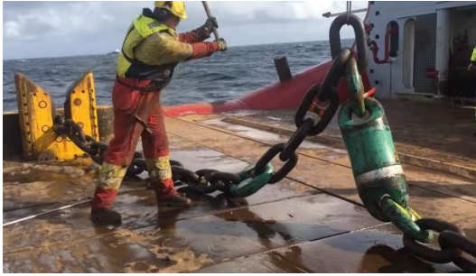
Figura 3.3.5.6 e Figura 3.3.5.7: Cadea fixada en cuberta nun Sharkyaw e apertura dun Kentle Shackle (Norway Maritime, 2023)
