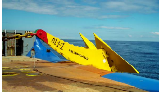
Figura 3.3.5.2: Áncora posicionada no rodillo de popa.
