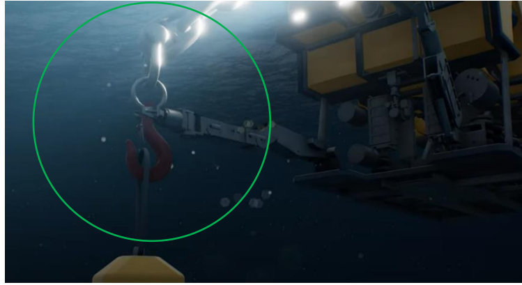
Figura 3.3.7.6: Gancho tipo Hook Sling (Green Pin Tycan, no date) Figura 3.3.7.7: Enganche da eslinga da boia de marca co Sling Hook (MAERSK SUPPLY SERVICE, 2021)
