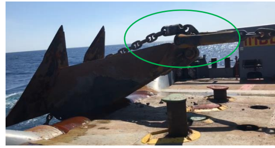
Figura 3.3.8.2: Áncora e Chaser Pendant a bordo dun AHTS (Johanis W V Karundeng, 2019)
