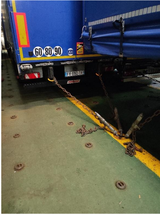
Figura 6.8.2.1. Trincaje a cuatro trincas de semirremolques. Fuente: Elaboración propia.
