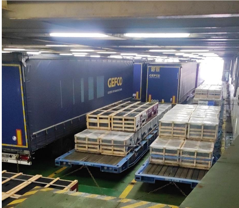
Figura 6.8.3.1. Trincaje de MAFI 40', cargado con pizarra. Fuente: Elaboración propia.
