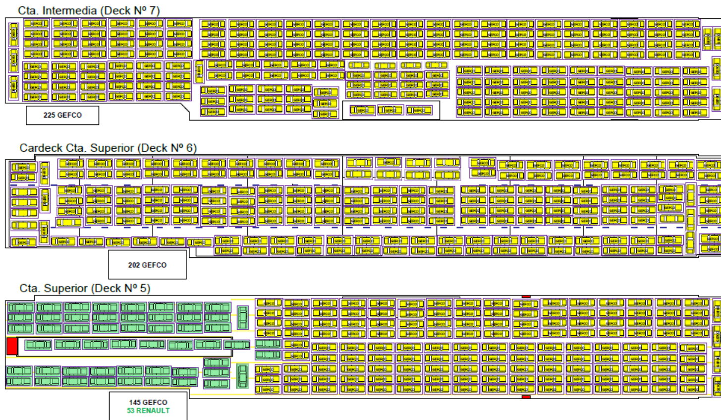
Figura 6.6.2. Plano de carga Deck N.º 5,6,7 buque SUAR VIGO. Fuente: Elaboración propia.
