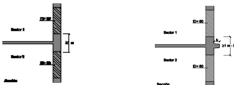
Figura 1.7. Encuentro forjado-fachada Figura 1.8. Encuentro forjado-fachada con saliente
