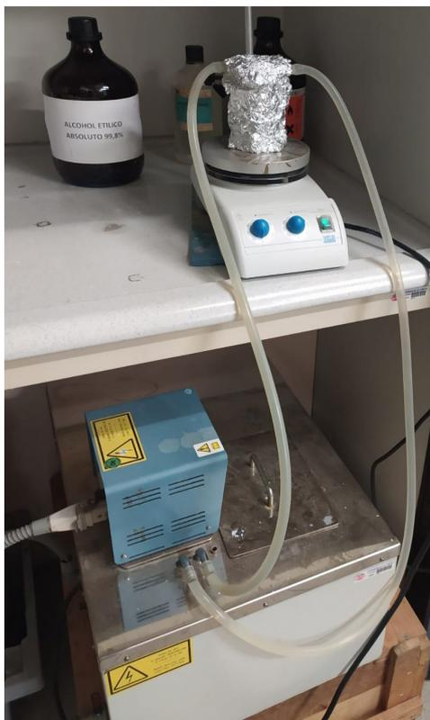
*Figura 9. Montaje de la Fotocatálisis en fase oscura.*
