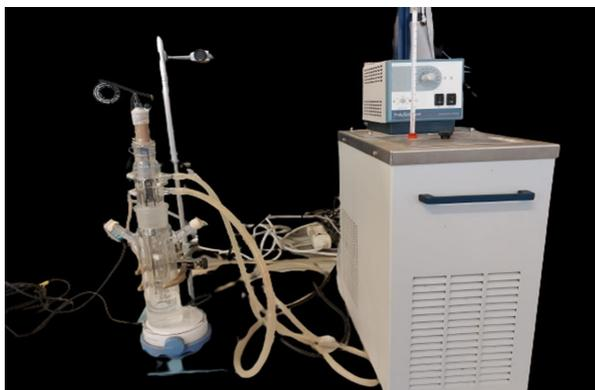
Figura 6. Imagen del montaje del fotorreactor cedida por Fátima Zaaboul
