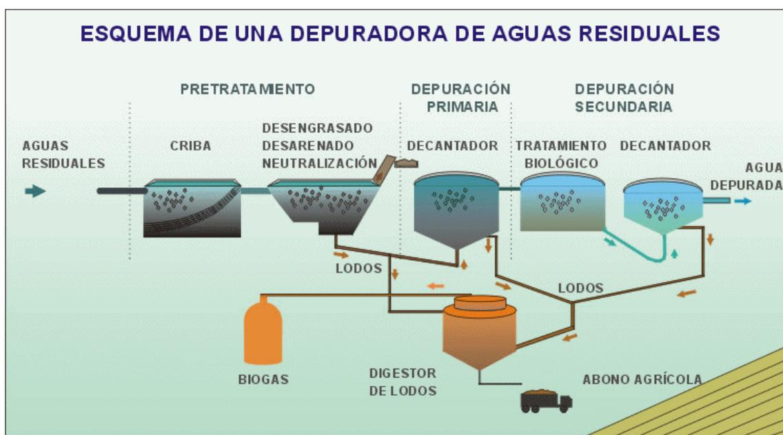
Figura 2. Esquema de proceso de depuración. Imagen de [www.aquaductoingenieria.es](http://www.aquaductoingenieria.es) [6]
