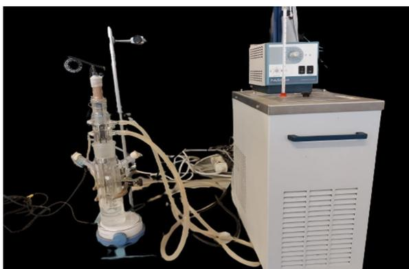
Figura 15. Montaje del reactor fotoquímico con la lámpara Visible. (Fotografía cedida por Fátima Zaaboul)
