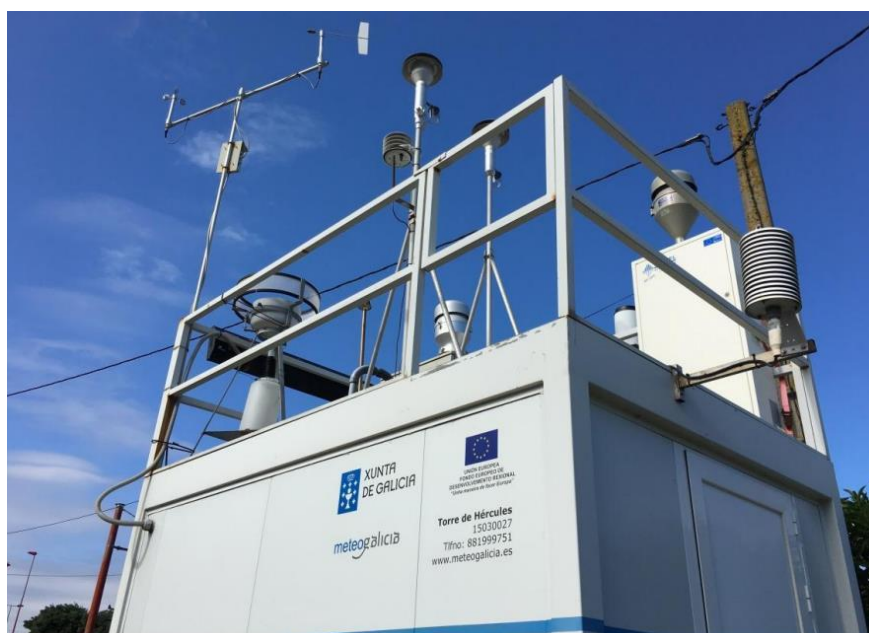
Figura 4: Captadores gravimétricos con cabezales PM_{10} y PM_{2.5} Torre de Hércules (Macho-Eiras et al., 2016).
