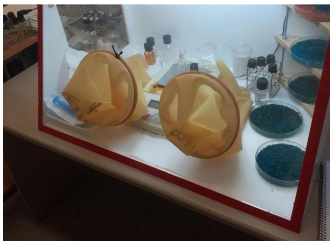
Figura 13. Cabina con humedad reducida.
