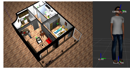
Figura 5: Izquierda: Ejemplo de un entorno de Gazebo importado desde SweetHome3D. Derecha: Modelo Blindbot
