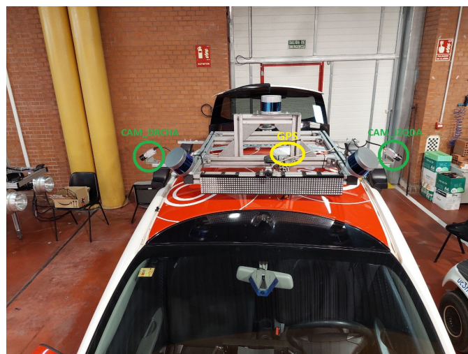
Figura 7: Disposición de los diferentes sensores en el vehículo
