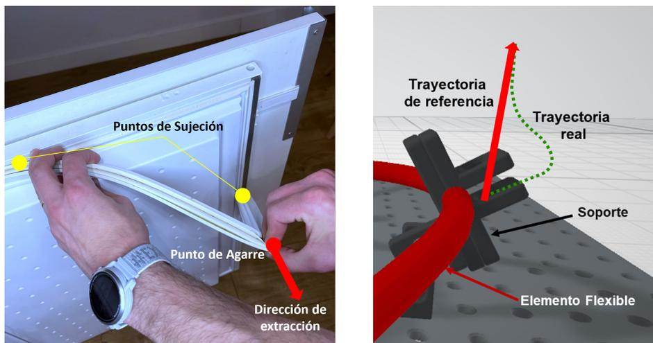
(a) Tarea de extracción de un elemento flexible de la puerta de un refrigerador de forma manual (b) Propuesta de validación para la tarea de extracción de elementos flexibles de forma automática
