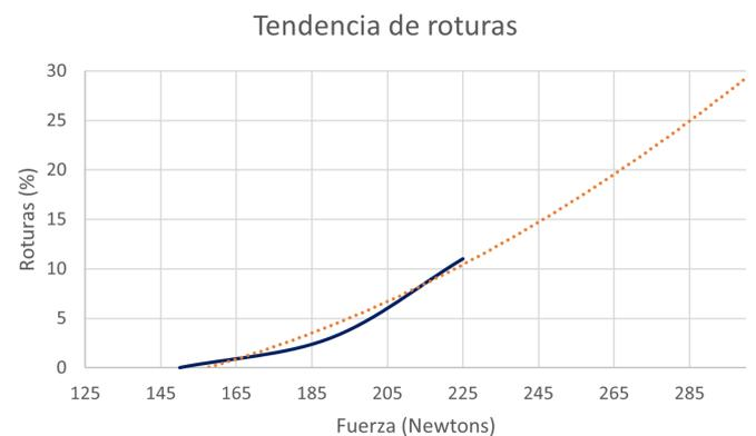
Figura 11: Tendencia de las situaciones de rotura acorde a la fuerza aplicada por el robot.
