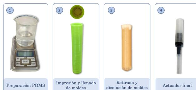
Figura 6: Fotografías tomadas durante las cuatro principales etapas de fabricación por moldeo de los actuadores excéntricos hechos de PDMS.
