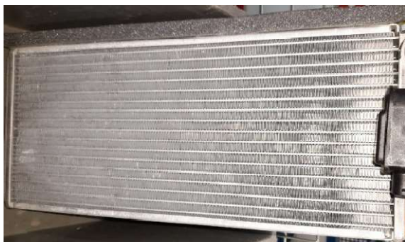
Figura 1: Intercambiador de calor.
