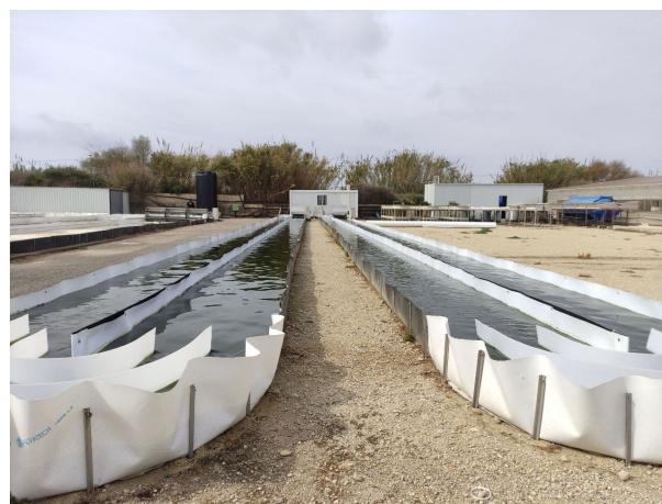
Figura 1: Fotobiorreactores raceway disponibles en las instalaciones del Convenio UAL-IFAPA
