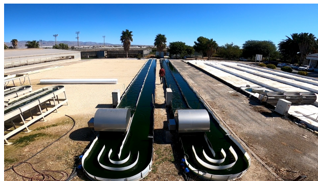
Figura 1: Raceway reactor en las instalaciones de IFAPA próximo a la Universidad de Almería (España)
