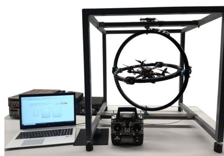
Figura 1: Plataforma para la orientación de un multirrotor.
