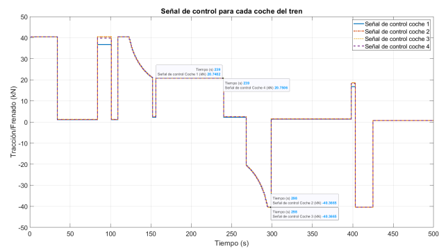
Figura 12: Señal de control para cada coche tras la ejecución del algoritmo asociado al ATO Subsystem y tras añadir perturbaciones a la vía
