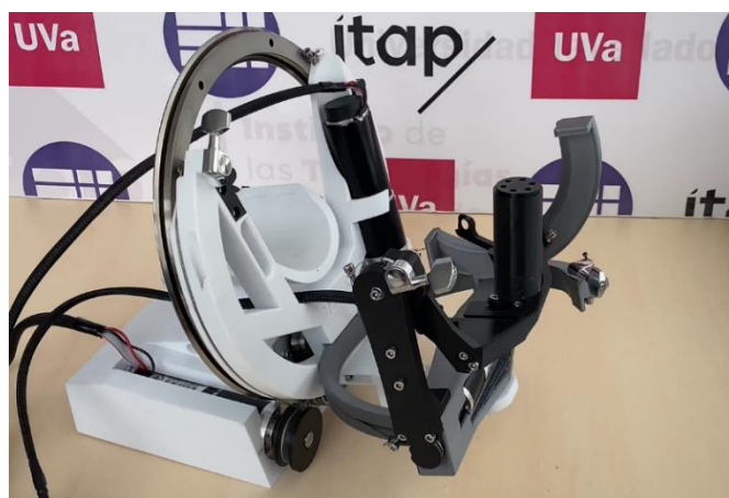
Figura 2: Dispositivo mecatrónico M3Rob, con la estructura fabricada mediante impresión 3D.
