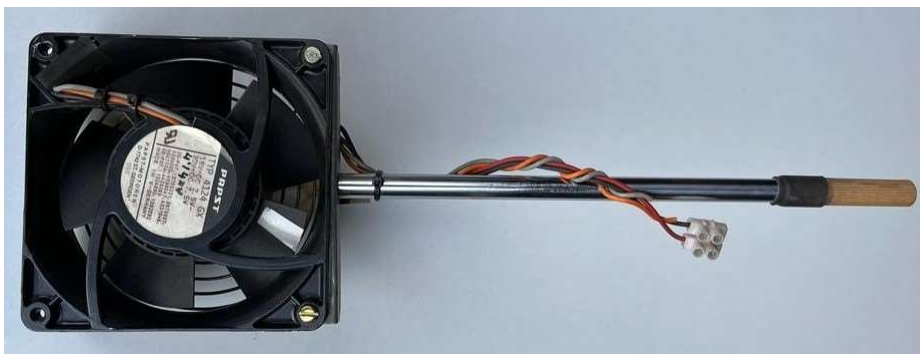
Figura 2.21. Anemómetro con ventilador PAPST.
