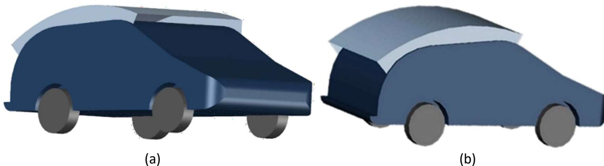
Figura 2.3. Diseño en Autocad 3D® del sistema deflector incorporado al vehículo.
