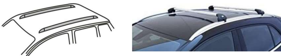
Figura 4.16. Barras longitudinales adheridas al techo.
