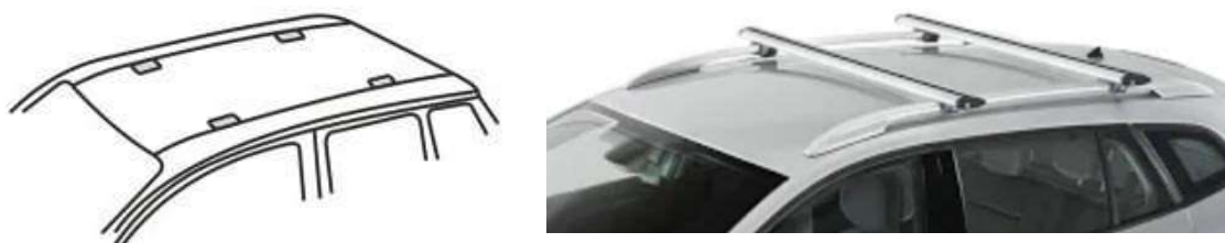
Figura 4.15. Anclaje basado en 4 puntos de anclaje.
