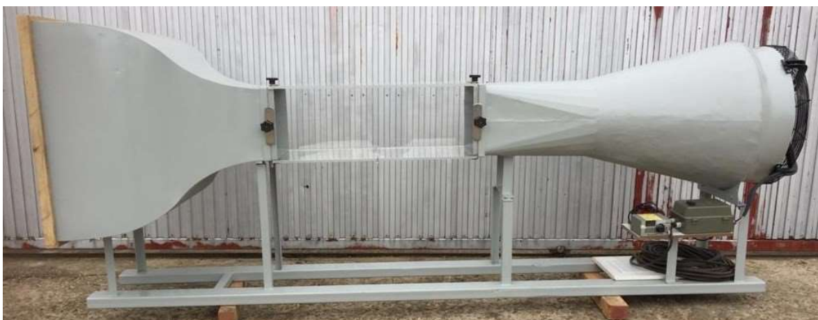
Figura 2.10. Túnel de viento construido en fase VII.I que alcanza 50 km/h.
