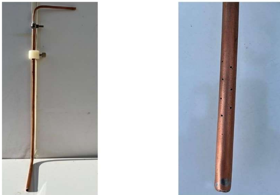
Figura 2.29. Tubo de Pitot: a) vista completa; b) orificios que miden la presión estática.
