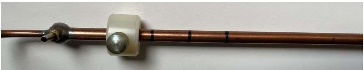
Figura 2.41. Marcas de referencia en tubo de Pitot.
