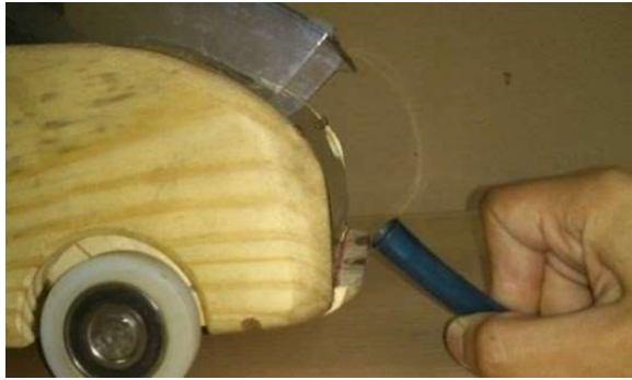
Figura 2.27. Medición directa con la columna de agua.
