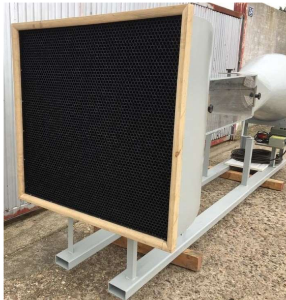
Figura 2.13. Acondicionador de flujo incorporado al túnel de viento.
