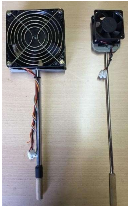
Figura 2.22. Anemómetros con ventilador Brushless.
