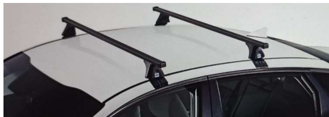
Figura 4.18. Garras abrochables a los extremos laterales del techo.
