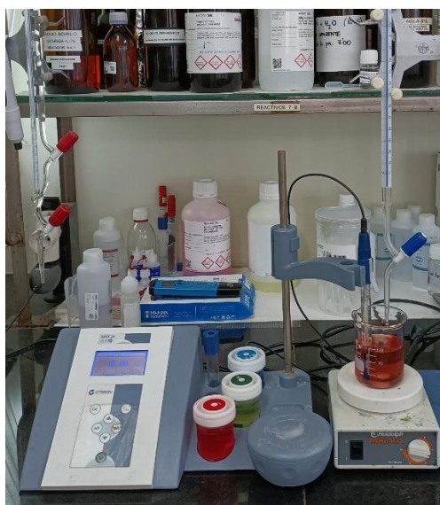
Figura 9: Montaje para la determinación del contenido en magnesio.
