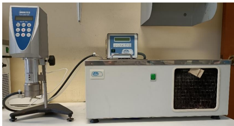
Figura 13: Viscosímetro y baño termostático empleados en el laboratorio de Arteixo Química S.L.U. (Brookfield).
