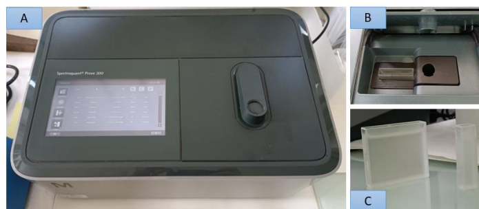
Figura 15: (A) Espectrofotómetro empleado en el laboratorio de Arteixo Química S.L.U. (Spectroquant Prove 300); (B) Cubeta colocada en el interior del espectrofotómetro para la medición; (C) Cubetas de vidrio de 50 mm y 10 mm.
