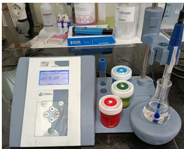
Figura 21: pH-metro empleado en el laboratorio de Arteixo Química S.L.U. (CRISON Basic 20)
