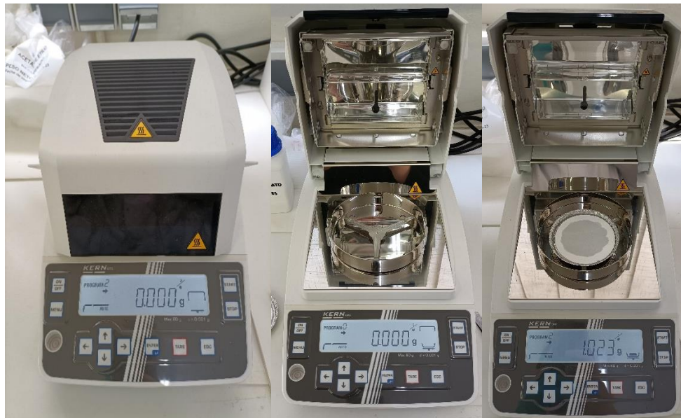
Figura 11: Termobalanza utilizada en el laboratorio de Arteixo Química S.L.U. (KERN DBS-A02).
