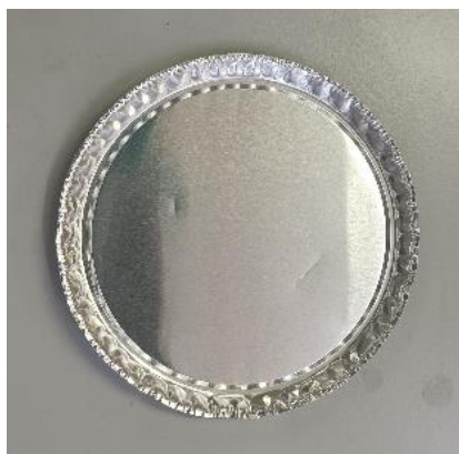
Figura 10: Platillo de aluminio empleado como soporte de sustancias sometidas a tratamientos térmicos.
