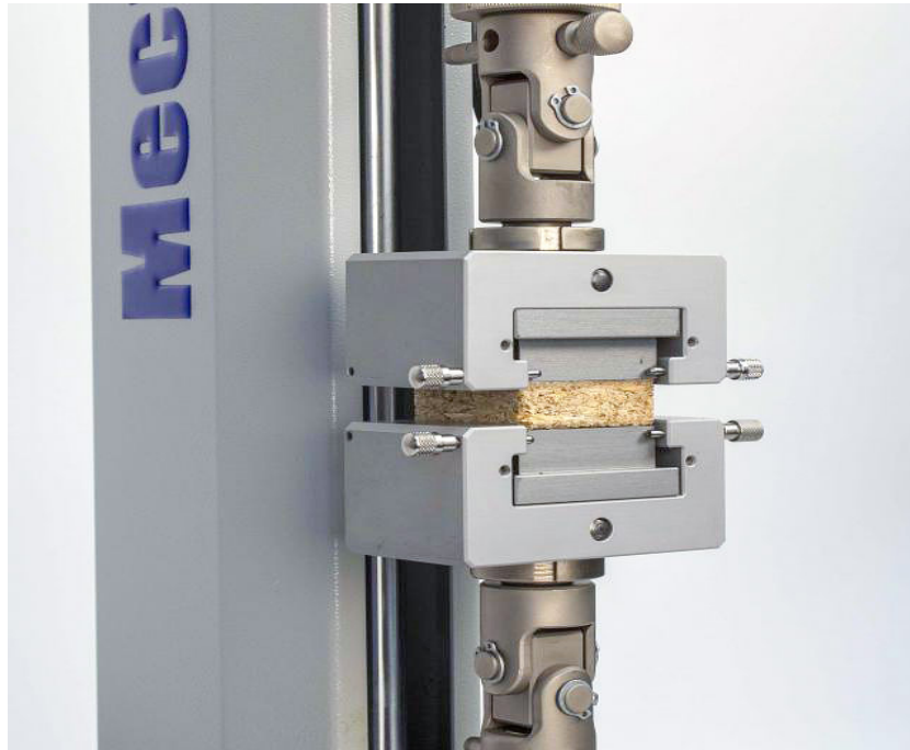
Figura 8: Instrumentación empleada en el ensayo de tracción. [10]
