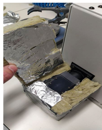
Figura A-2. Forno de lá de rocha empregado nos estudos de conversión
